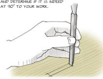
USE THE CUTTING EDGE TO DEFINE YOUR LAYOUT LINES BEFORE REMOVING WASTE
